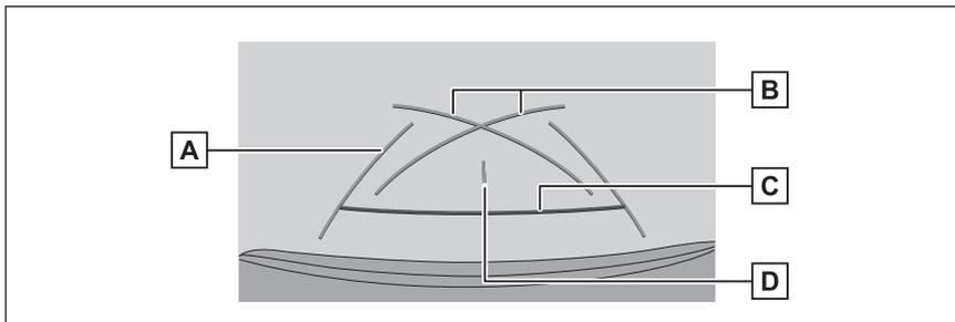
**A** Направляющие линии с указанием ширины автомобиля
