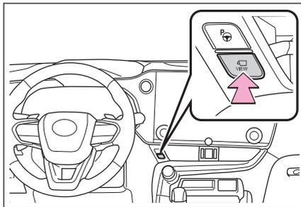
**Отображение экрана системы панорамного вида**
